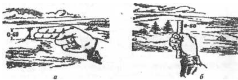
Рис. 8.25. Вимірювання кутів: а - за допомогою пальців руки; б - за допомогою лінійки (підручних предметів)
