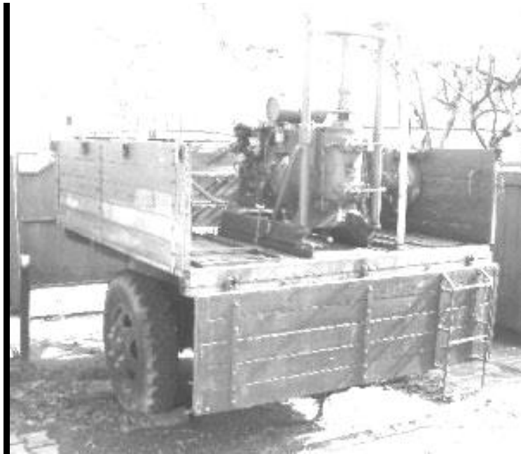
Рис.3. установка добування води УДВ-15 – бурова установка ПБУ-50 (ПБУ-50М, ПБУ-200), яка призначена для добування підземних вод у польових умовах шляхом обладнання тимчасових та постійних свердловин та шахтних колодязів (рис.4).
