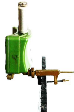
Рис.4. Встановлення МОН-50 на дереві та листі металу: а – на дереві; б – на листі металу..
