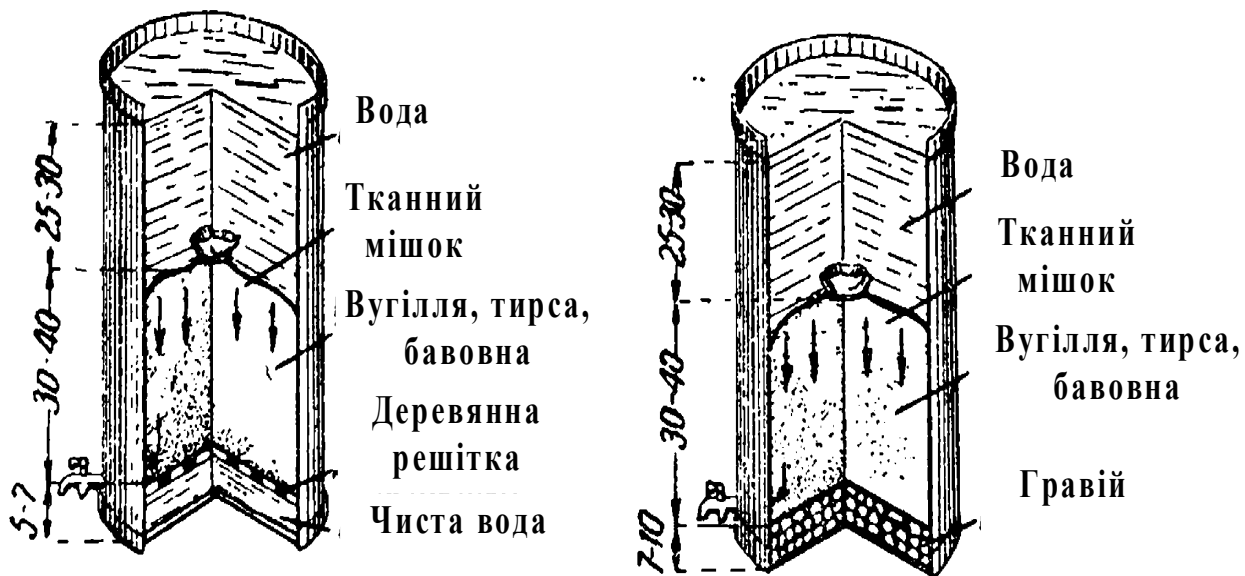
Рис. 1.2. Фільтр з фільтруючим матеріалом в тканинному мішку
