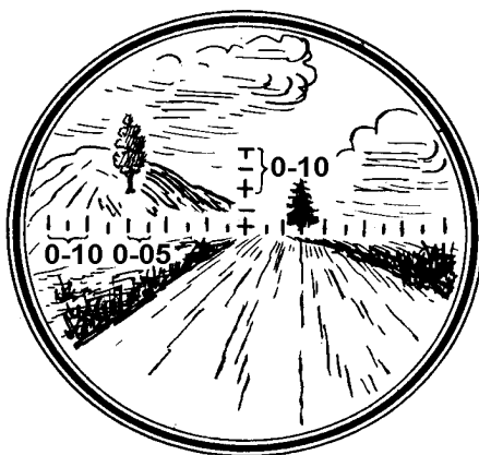
Рис. 7. Визначення кутів за допомогою бінокля
