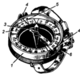
Рис. 1. Компас Адріанова: 1 - корпус; 2 - шкала (лімб); 3 - магнітна стрілка; 4 - візирний пристрій (мушка і цілик); 5 - покажчик відліків; 6 - гальмо
