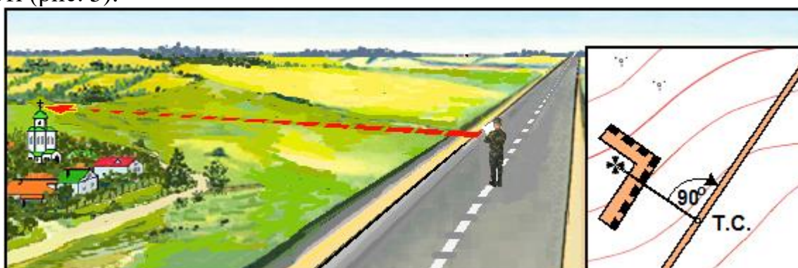
Рис. 5. Визначення точки стояння способом перпендикуляра
